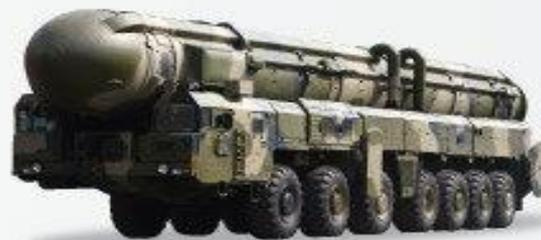
Межконтинентальная баллистическая ракета РС-24 «Ярс» разработана на основе РС-12М2 «Тополь-М»
