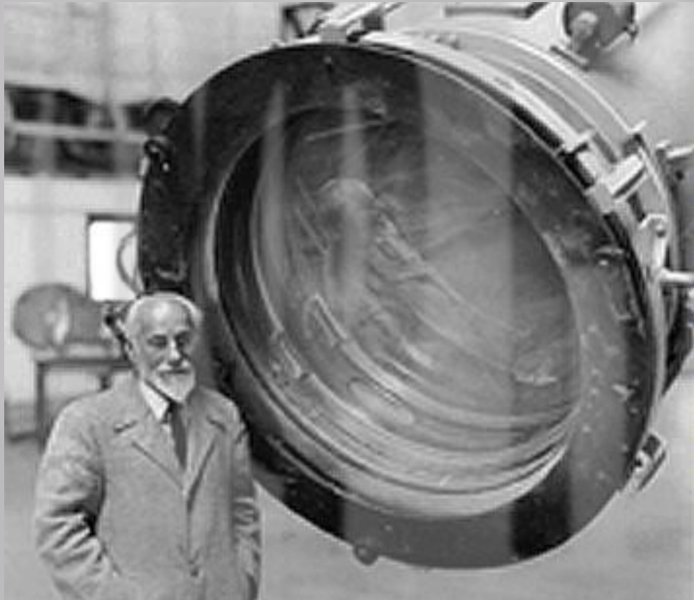
Ахромат Йеркской обсерватории. США. 1896 год. D=102 см, M=225 кг.
