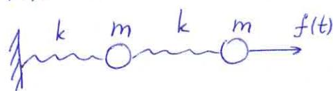
$$\begin{pmatrix} m & 0 \\ 0 & m \end{pmatrix} \begin{pmatrix} \ddot{x}_1 \\ \ddot{x}_2 \end{pmatrix} + \begin{pmatrix} 2k & -k \\ -k & k \end{pmatrix} \begin{pmatrix} x_1 \\ x_2 \end{pmatrix} = \begin{pmatrix} 0 \\ f(t) \end{pmatrix}$$
