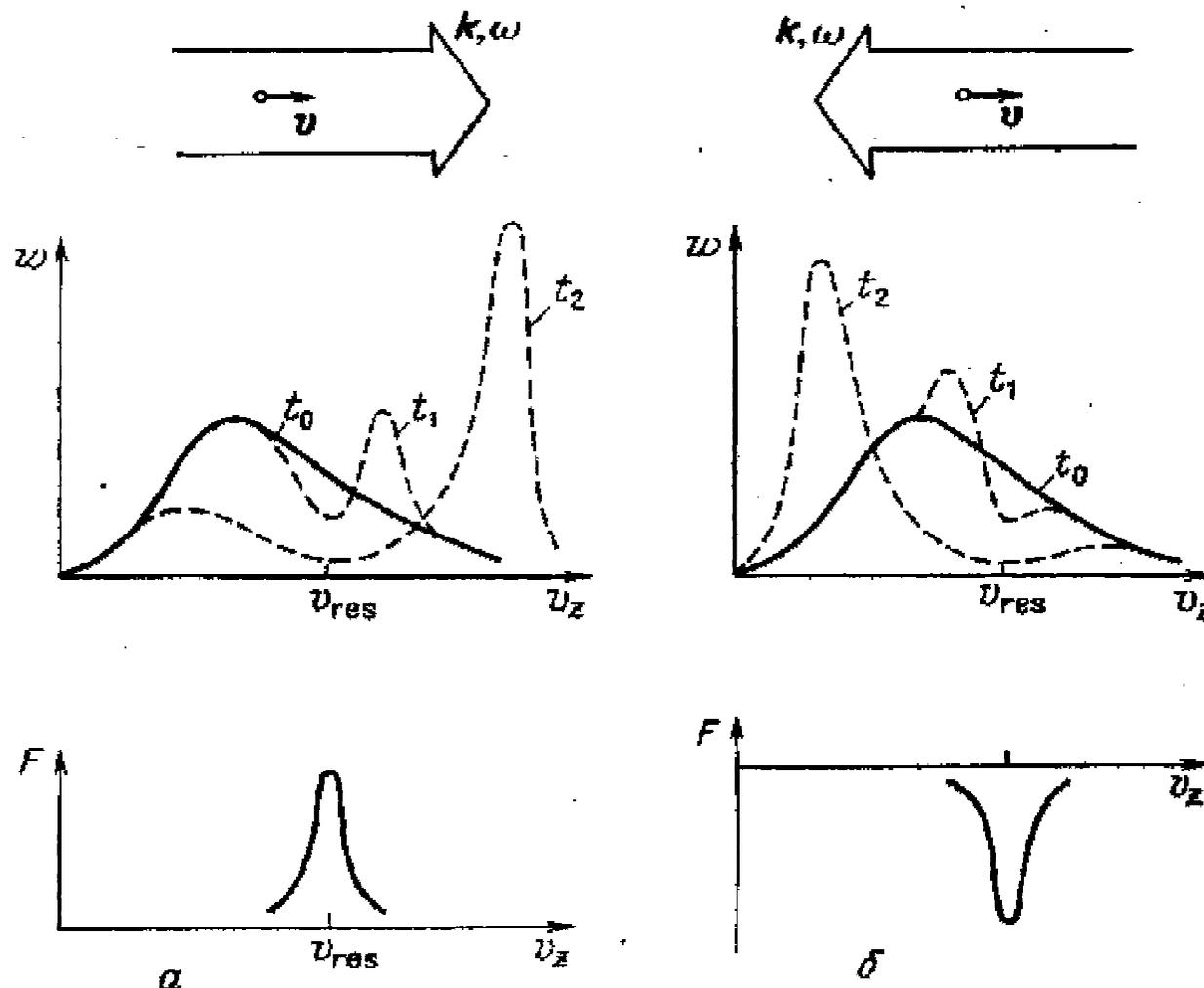
Рис. 5.1. Качественный характер деформации скоростного распределения  $w(v_z)$  ансамбля атомов и зависимость силы светового давления  $F$  от проекции скорости  $v_z$  ( $t_0 < t_1 < t_2$ )
