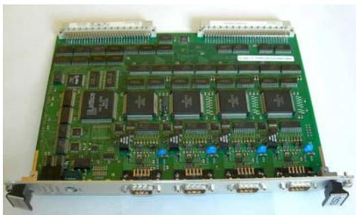
*Рис. 7.* VME-модуль с 32-разрядной шиной данных
