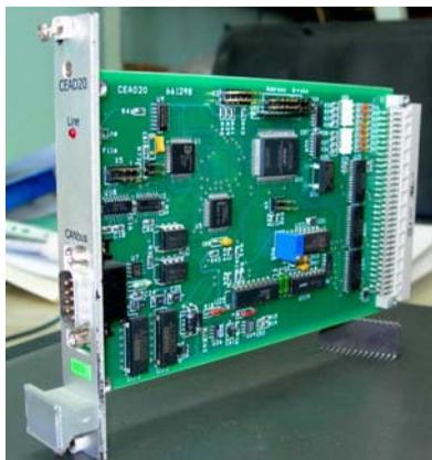
Рис. 2. Модуль в конструктиве «Евромеханика» одинарной ширины высотой 3U
