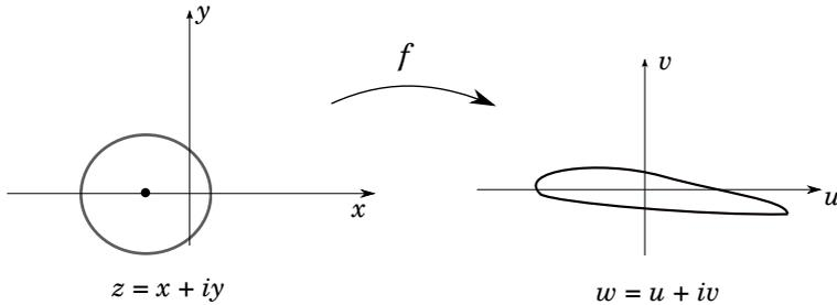
Функция Жуковского отображает окружность на некую замкнутую кривую, подобную профилю самолётного крыла. Вариацией радиуса и положения круга относительно начала координат  $z = 0$  можно менять угол изгиба и толщину крыла.
