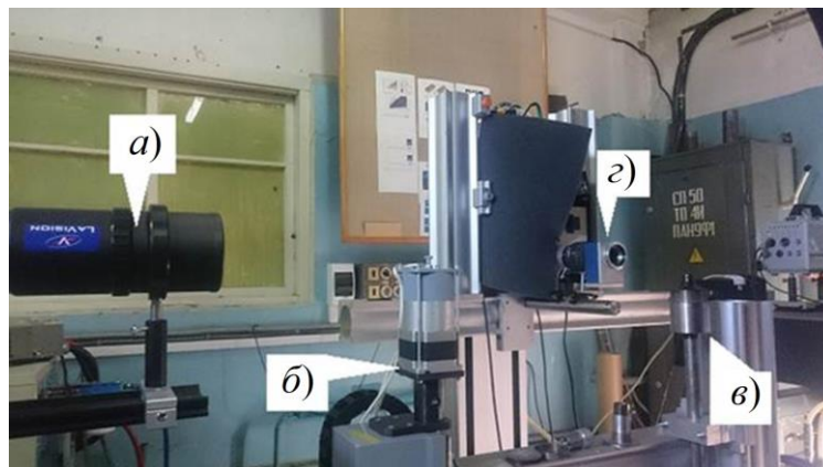
Рис. 3. Внешний вид экспериментальной установки: а – коллимирующая оптика; б – привод координатного устройства; в – горелка; г – фильтр Лио-Эмана с «Notch» фильтром
