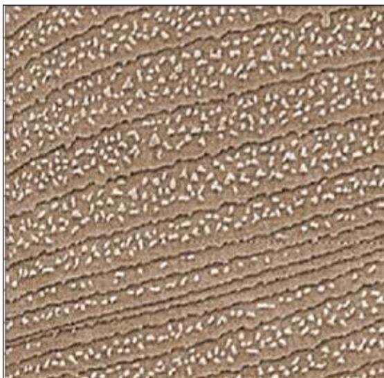
АСМ-изображение поверхности кремния (111), содержащей моноатомные ступени и двумерные островки кремния высотой 0,31 нм
