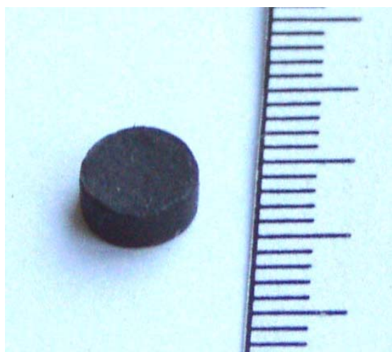
Рис. 1. Спек сверхтвёрдого кубического нитрида кремния, полученного взрывным синтезом
