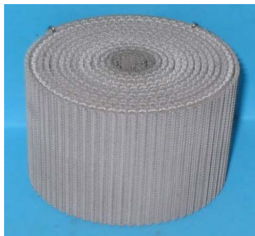
Рис. 2. Оксидные покрытия из тугоплавкого сплава на сетке, полученные детонационным напылением
