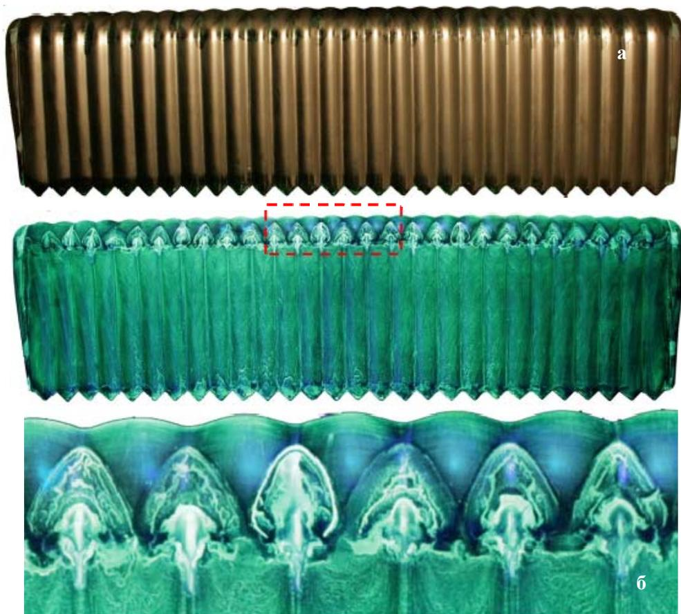
Рис. 2. Визуализация на волнистом крыле при  $Re = 1,55 \cdot 10^5$ ,  $\alpha = 9^\circ$  в обычном (а) и ультрафиолетовом (б) освещении
