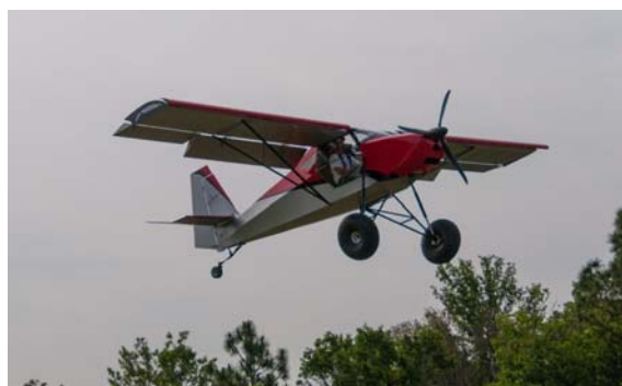
Рис. 20. Сверхлегкий самолет укороченного взлета и посадки Super STOL
