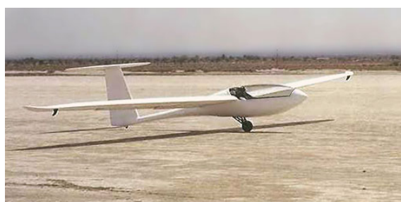
Рис. 19. Планер Light Hawk, взлетный вес 200 кг
