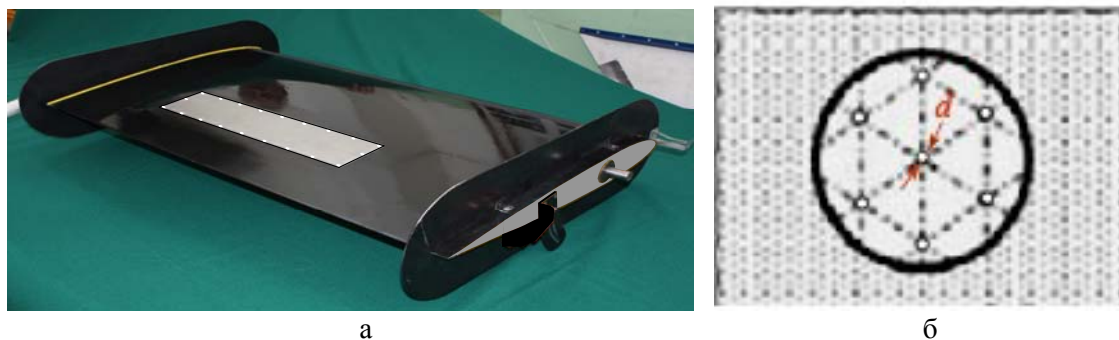
Рис. 9. Фотография модели прямого крыла с перфорированным вкладышем (а) и параметры проницаемости перфорированной поверхности (б): пористость 17,1 %, средний диаметр пор (отверстий), расположенных в шахматном порядке, d = 0,17 мм, толщина стенки 1,1 мм, удлинение пор 6,7
